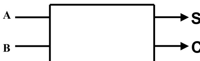
Representación esquemática de un sumador
