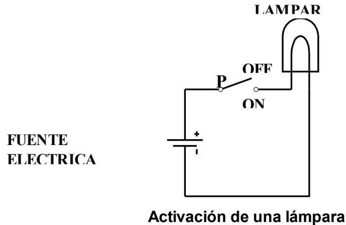
La lámpara se encenderá siempre que se cierre el circuito, es decir, cuando **P** adquiera la posición “**ON**” y se apagará cuando se abra el circuito, o sea cuando **P** tome la posición “**OFF**”.
